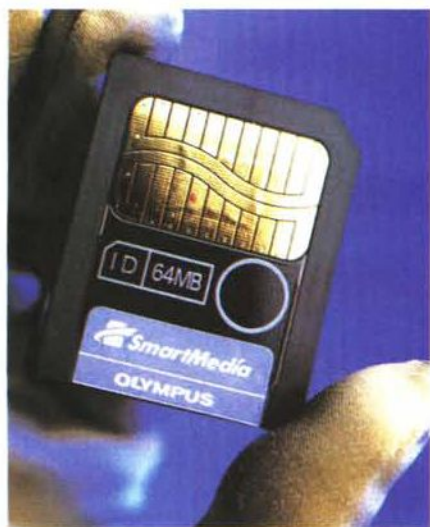
Due esempi di memorie a stato solido per fotocamere digitali (e non solo...). La SmartMedia ricorda - per dimensione e spessore - un francobollo; le Memory Stick - proposte già da qualche anno dall'instancabile Sony - sono simpaticamente indicate come memorie formato chewing gum.
